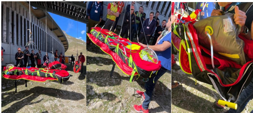
Figur 1 Bære utviklet av PAX i samarbeid med AirZermatt, ingen borrelåser. Integreert vacuummadrass. Heisestopper pakket i glidelåslommer på siden for enkel tilgang.
